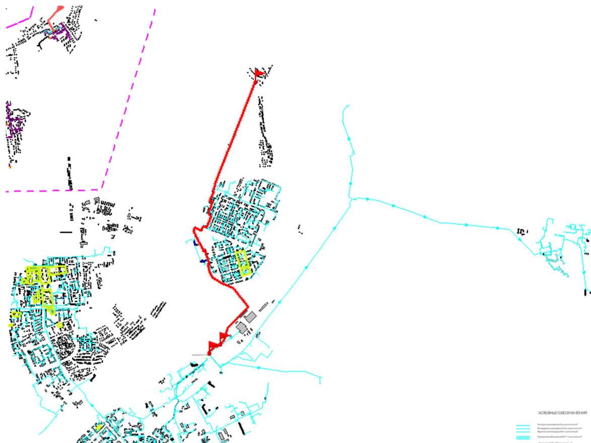
Рисунок 2.7 – Путь для расчёта вероятности безотказной работы тепловых сетей от Архангельской ТЭЦ до потребителя ИП Зеленин
